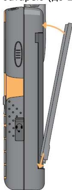
**3.** Выдвиньте и поверните антенну в рабочее положение
