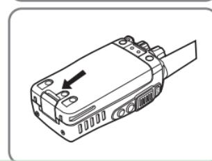
Прижмите нижнюю часть аккумулятора и закрепите защелкой
