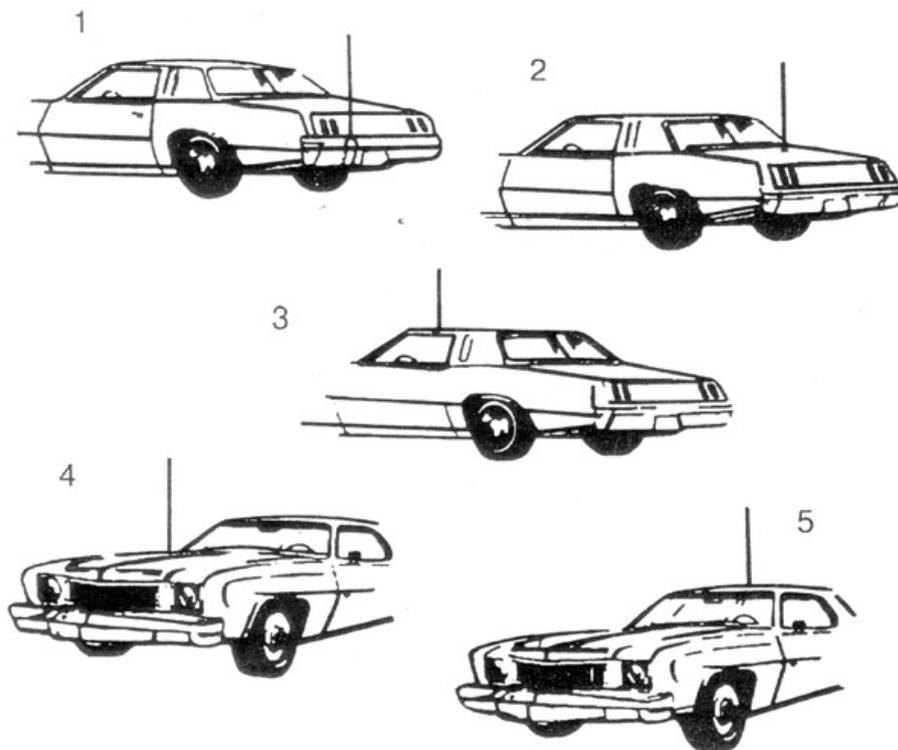
Рис. 6. Типичные места установки автомобильных антенн.
